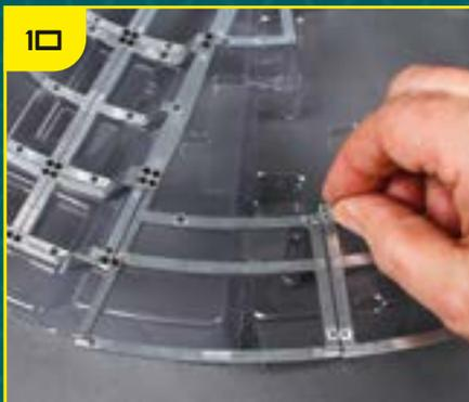
Расположите соединительную накладку с двумя отверстиями на стыке рам TF-01 и TF-38, как показано.
