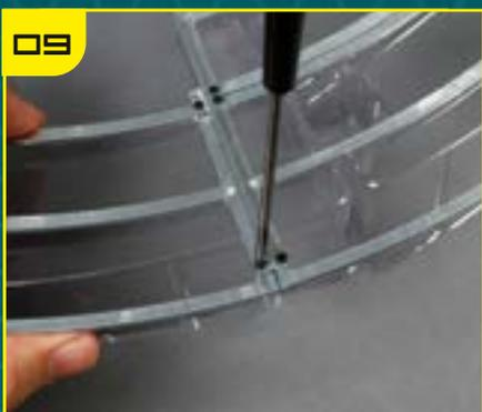
Зафиксируйте раму TF-38, закрутив винты в оба фланца ребра жесткости.
