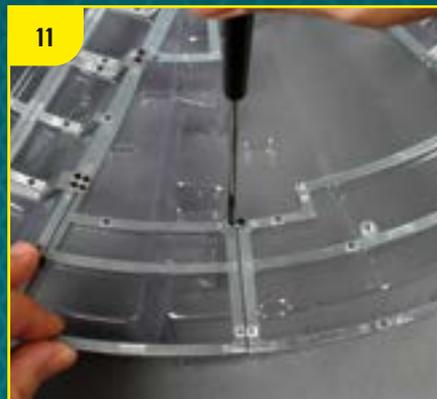
Зафиксируйте накладку с помощью двух винтов.
