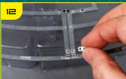
Расположите вторую соединительную накладку с двумя отверстиями на стыке рам TF-01 и TF-38.
