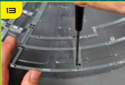
Зафиксируйте накладку с помощью двух винтов.
