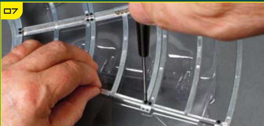
Закрутите винты в оба фланца ребра жесткости.
